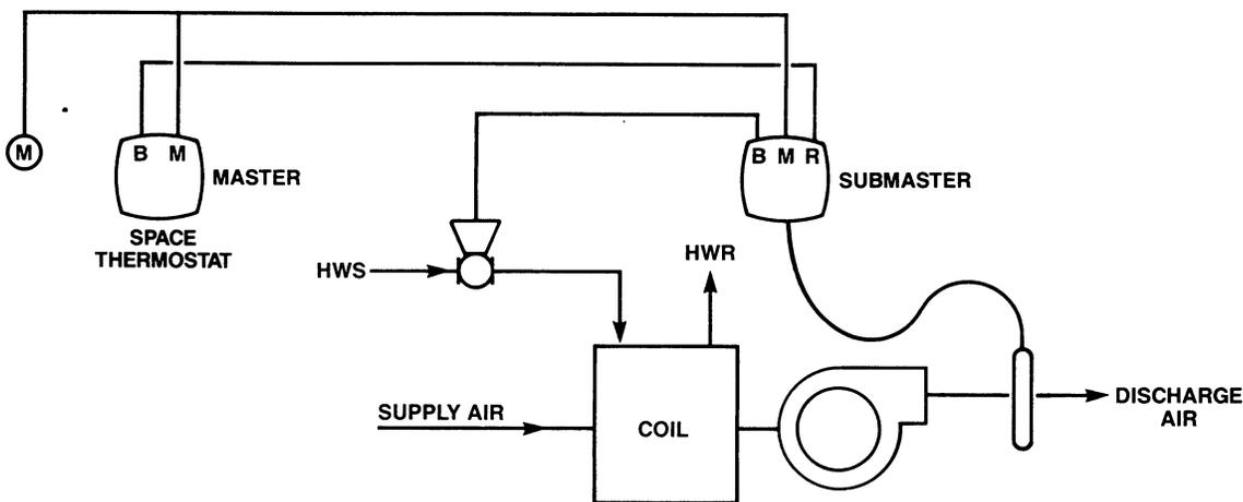
**RESET CONTROL OF UNIT DISCHARGE TEMPERATURE
