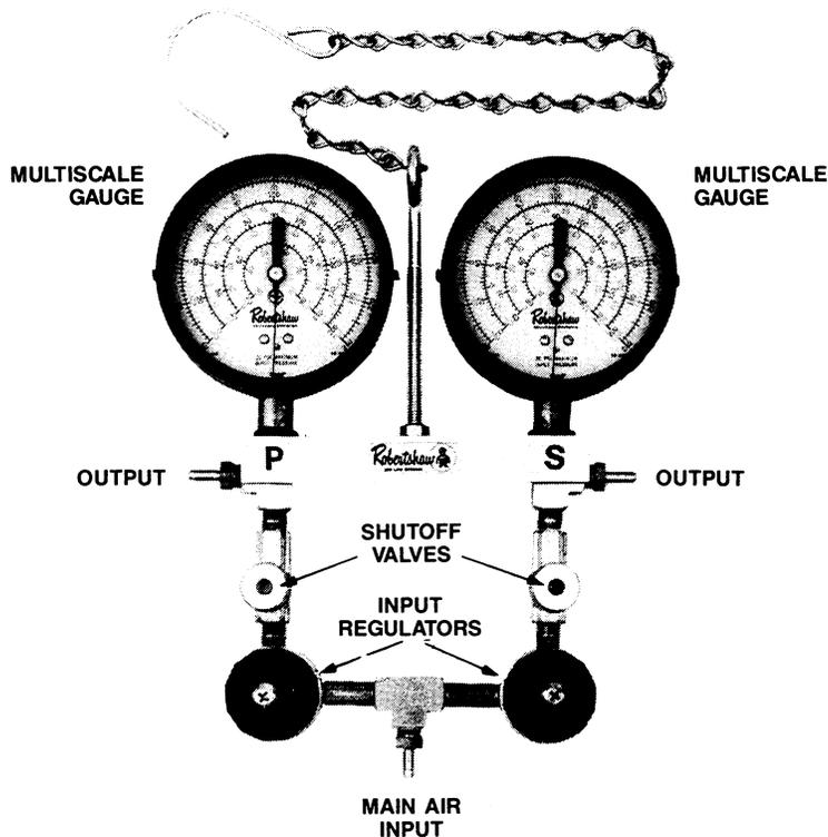
900-012 RECEIVER CONTROLLER/TRANSMITTER CALIBRATION KIT
