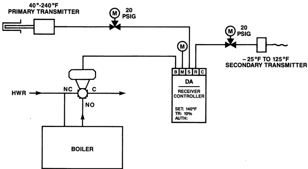
DUAL INPUT RECEIVER CONTROLLER APPLICATION
