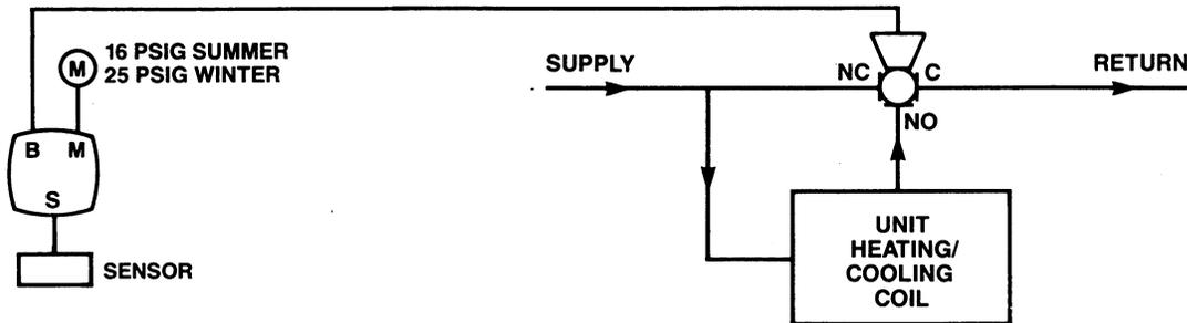
**DUAL PRESSURE UNIT TEMPERATURE CONTROLLER
